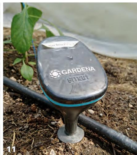
9 Einbau eines Bodenfeuchtefühlers 10 Bewässerungscomputer mit Druckminderer 11 Bodenfeuchtefühler zur smarten Steuerung der Bewässerungsanlage
