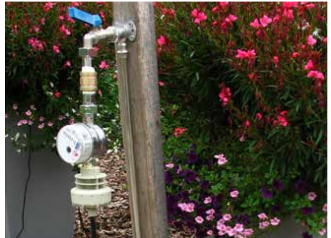
Tropf-Blumat: Wasseruhr, Druckminderer mit Filter
